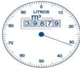
MARCA AUTOMATICAMENTE SU CONSUMO DE AGUA EN METROS CUBICOS, LA ULTIMA CIFRA MARCA SOLAMENTE LITROS LECTURA: 3987 M³
